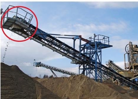
大型输送机通常延伸距离大且有几种高度，难以接近。最适合在设备运行时进行再润滑。通常只能借助梯子或其他辅助设备到达存储容器或处理设施上方转移点处的润滑点，因此往往受到忽视。由于有害的环境条件危及工作场所安全而限制进入。
